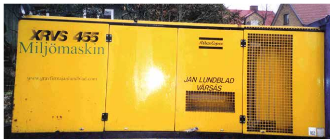
Miljömaskin. I Sverige försöker vi aktivt minska vårt beroende av olja och el. Miljömaskinen på bilden är en del av den borrarutrustning som används för att installera bergvärme i ett villaområde. Ett byte från direktverkande el till bergvärme sänker elförbrukningen med mer än 50 %.
