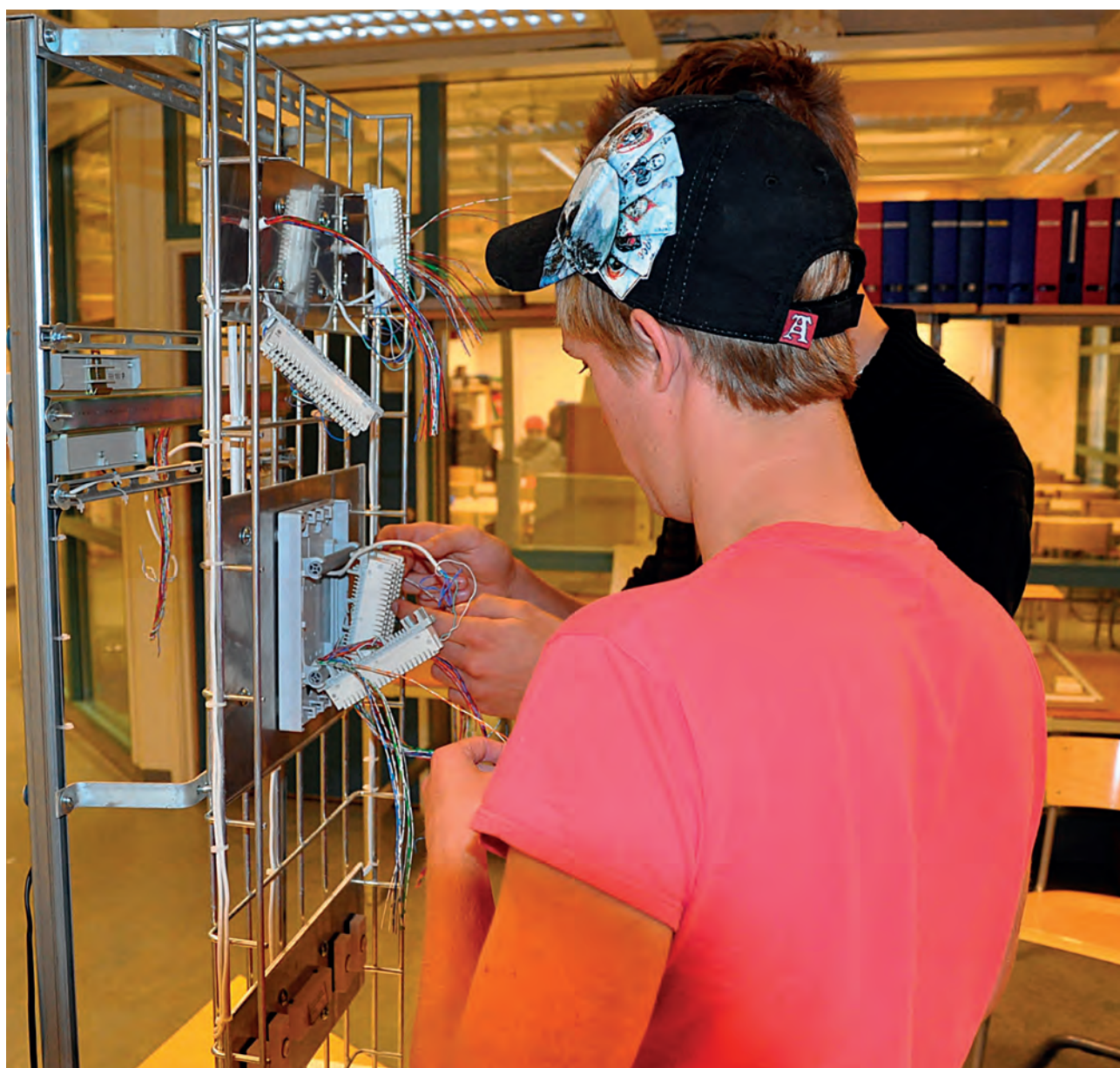
Med hjälp av en praktisk övning med ett kallelse-signalsystem lär du dig grunderna i nätuppbbyggnad och dokumentation.
