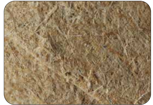
Vid stark förstoring syns fibrerna i ett material. Bilden visar fibrer av cellulosa i en papprulle för toapapper.
