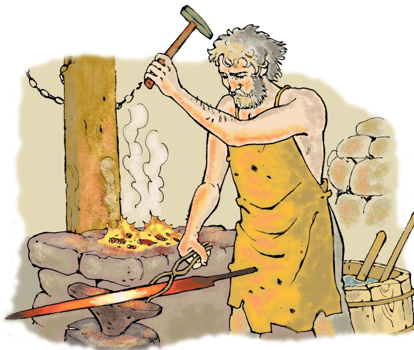
Smeden tillverkar ett svärd. Han håller svärdet mot ett städ med hjälp av en tång.
