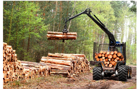
Idag används skogsmaskiner, som skördare och skotare i skogen. Skördaren sågar ned, kvistar och kapar träden. Skotaren fraktar stockarna fram till en väg.
