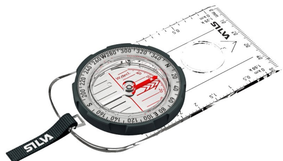
På en kompass visar alltid den röda pilen, nordänden, mot Nordpolen.
