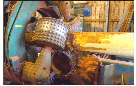
När en barkmaskin tar av barken på timmer är det en mekanisk process .
