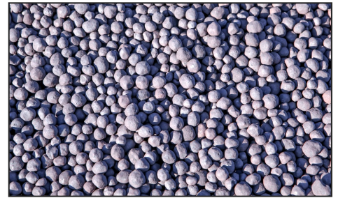
3. Järnmalmen formas till små kulor i ett sinterverk.
