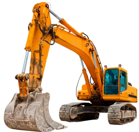
En grävmaskin kan överföra stora krafter med hjälp av hydraulik . Då används olja som sätts under högt tryck.
