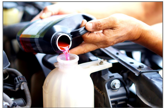
Påfyllning av kylarvätska. Eftersom många bilmotorer blir för varma av spillvärmerna , måste motorerna kylas ner. Därför har bilar kylsystem.
