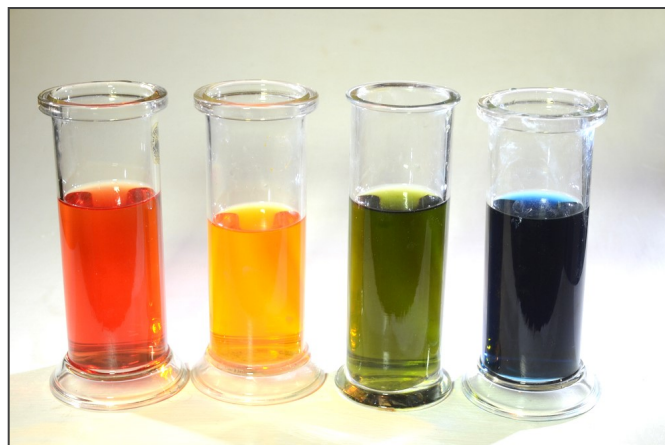
BTB är en kemiskt tillverkad indikator. Från vänster blir den röd i mycket sur lösning, sedan gul i något mindre sur lösning. Därpå grön i neutral lösning, samt blå i basisk lösning.
